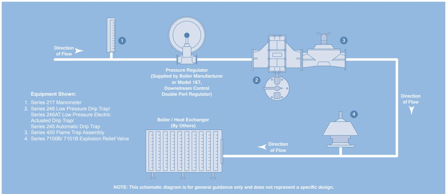
DIAGRAM 3: DIGESTER GAS TO ENGINE GENERATOR
